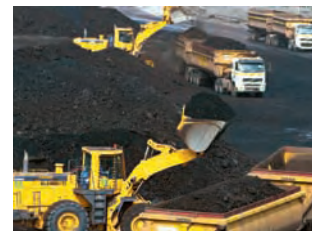
Truk gandeng menanti pemuatan batubara sebelum berangkat ke Pelabuhan Sungai Kelanis melalui jalan Hauling sepanjang 75 km.
